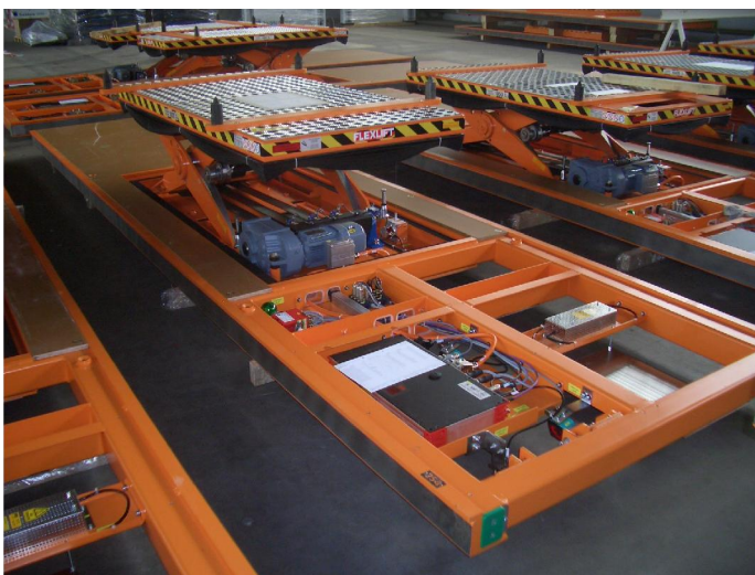
Die Hochleistungselektronik der Montageplattform wird durch hochwertig begehbare Holzplatten komplett verdeckt. (Foto AFT)
