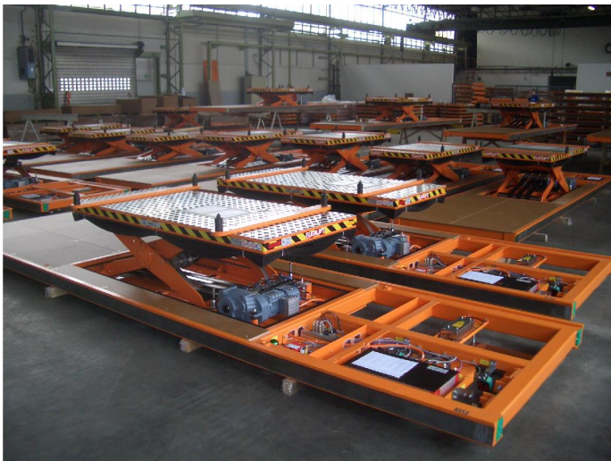
Zurzeit werden die gesamten 120 Montageplattformen in Bautzen ausgerüstet und getestet. (Foto AFT)
